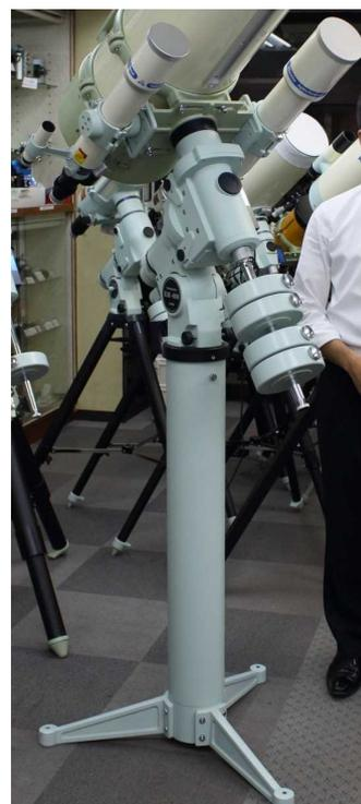
右は主・副望遠鏡を取り付ける赤道儀架台部分
